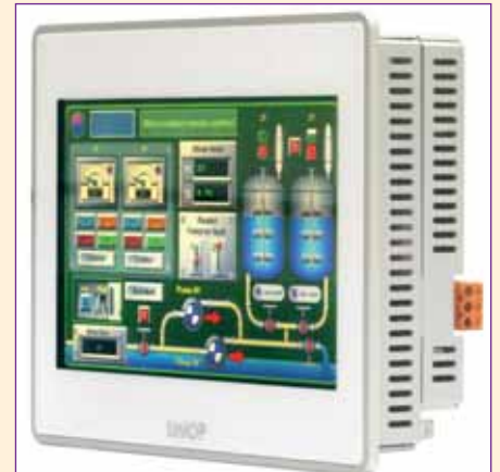
Het nieuwe Exor bedieningspaneel uit de eTOP300 serie: de eTOP307
