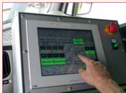
Slechts één bedieningspaneel met diverse door ART4 geprogrammeerde pagina's voor het visualiseren, bedienen, instellen, en bewaken van de installatie
