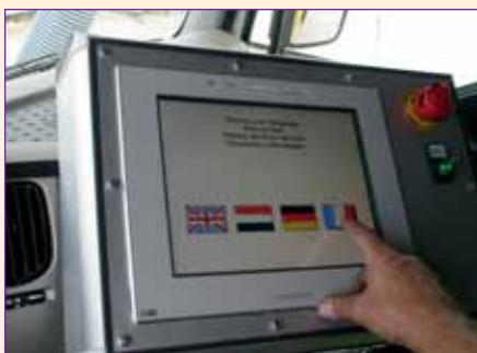
Slechts één bedieningspaneel met diverse door ART4 geprogrammeerde pagina's voor het visualiseren, bedienen, instellen, en bewaken van de installatie
