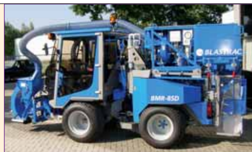
Trekker met een straalmachine voor het opruwen en reinigen van grote horizontale oppervlakten
