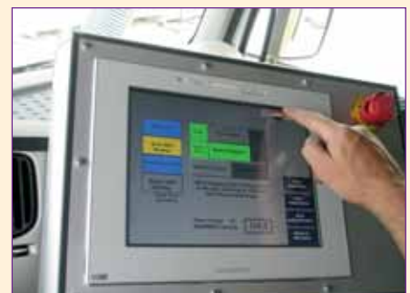
Slechts één bedieningspaneel met diverse door ART4 geprogrammeerde pagina's voor het visualiseren, bedienen, instellen, en bewaken van de installatie
