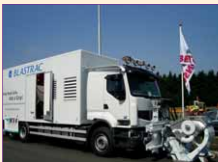
Een vergelijkbare straalmachine kan ook worden gekoppeld aan een vrachtwagen
